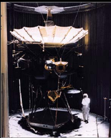
Galileo в испытательной камере, моделирующей условия, максимально приближенные к ожидаемым во время выполнения миссии.
